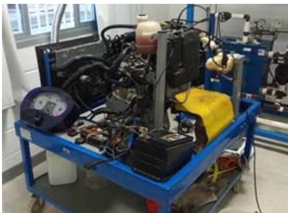
Figura 1. Motor de bancada Renault Clío 1.6 total flex.
