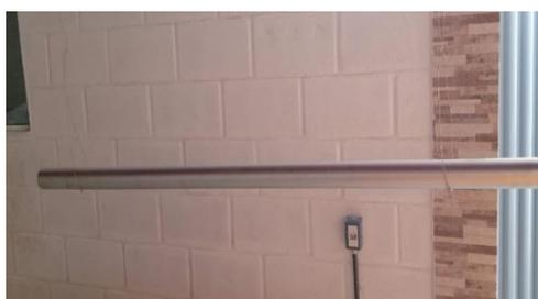
Figura 2. Tubo em alumínio anodizado suspenso na posição horizontal.
