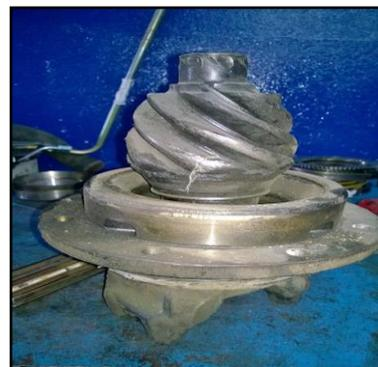
Figura 5. Corona Principal del diferencial con desgaste. Fuente: Registros de mantenimiento de la empresa de transporte colectivo urbano, 2014.
